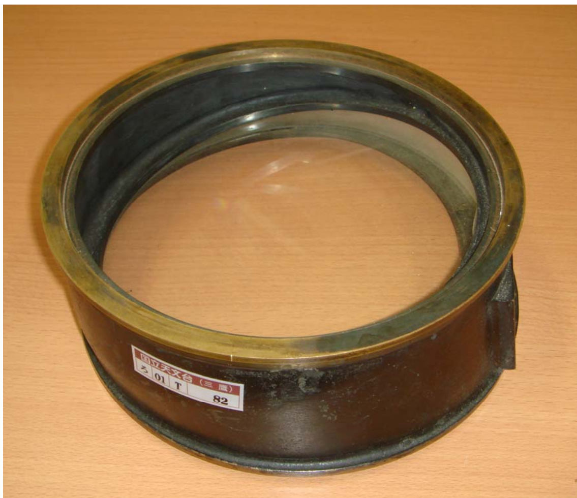
写真 4 木箱から出てきた口径 20cm の対物プリズム
