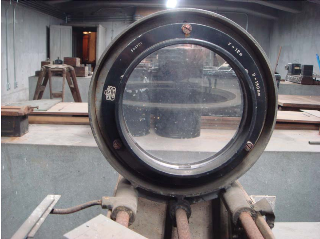
写真5 焦点距離12mのコリメーターレンズ
