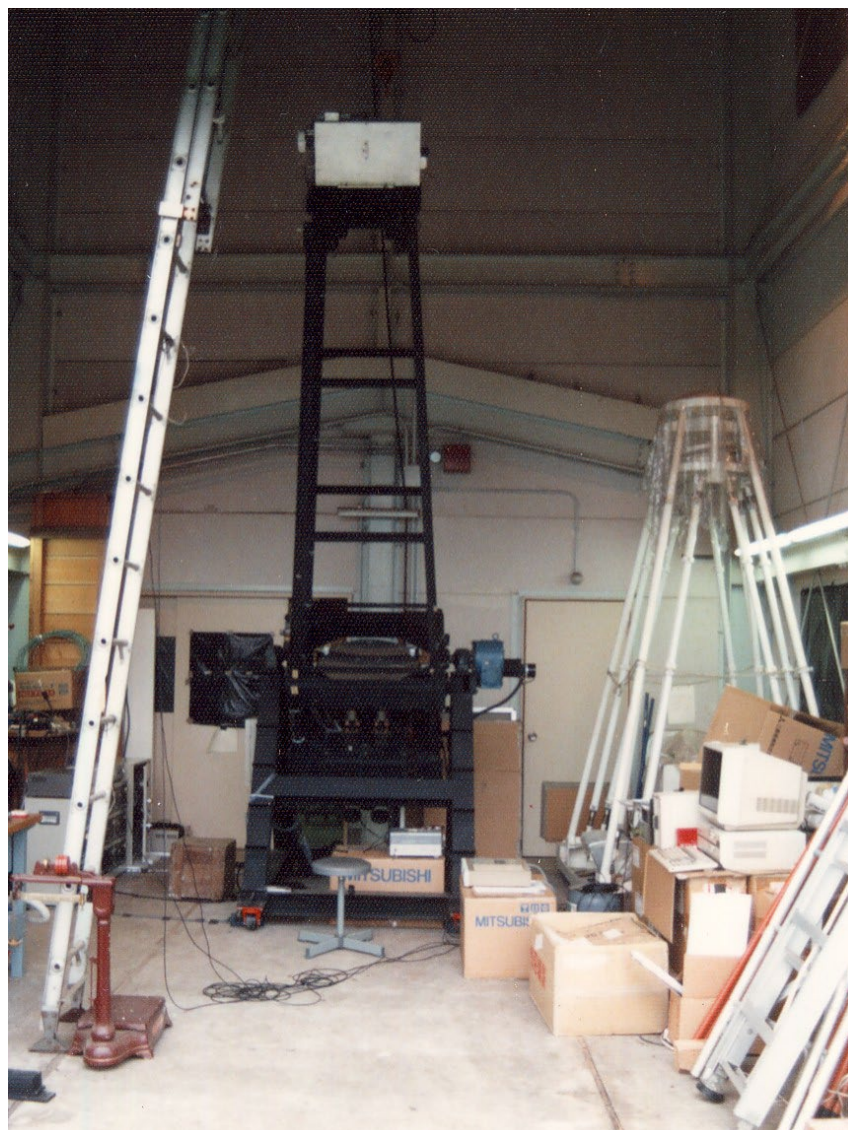
写真5 すばるの61cm鏡の能動制御試験装置と30cm気球望遠鏡
