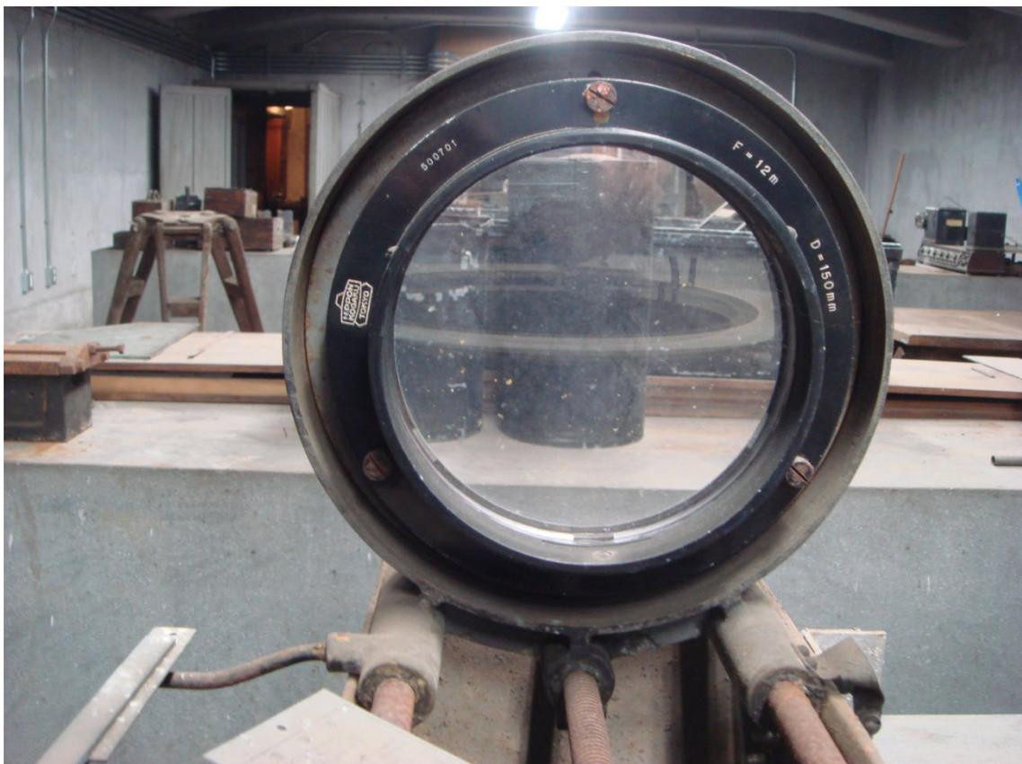
写真5 焦点距離14mのコリメーター・カメラレンズ
