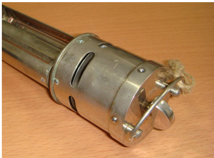
写真2 上部のゼンマイ式通風機構部
