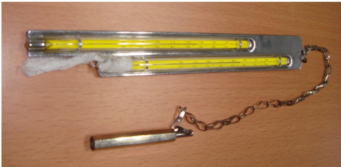
写真1 乗鞍コロナ観測所で発見した振廻乾湿度計
