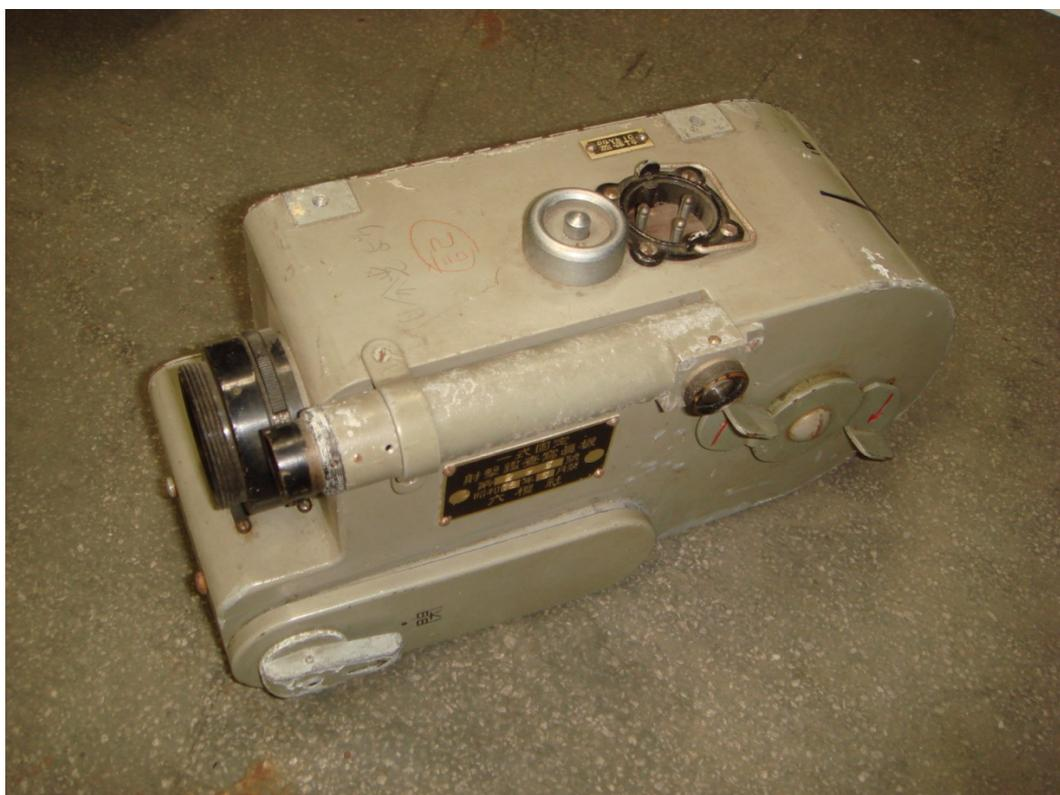
写真1 射撃監査写真機
