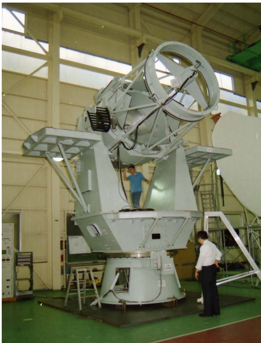
写真1 工場で完成した1.5m 赤外線シミュレータ
