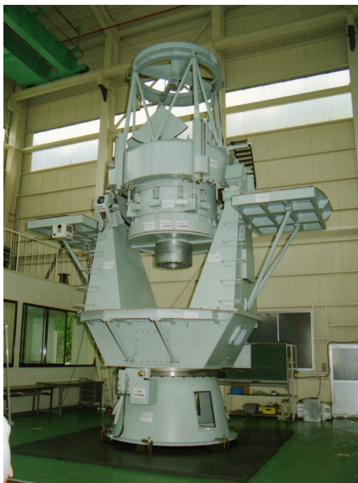
写真 2 1.5m 赤外シミュレータ
