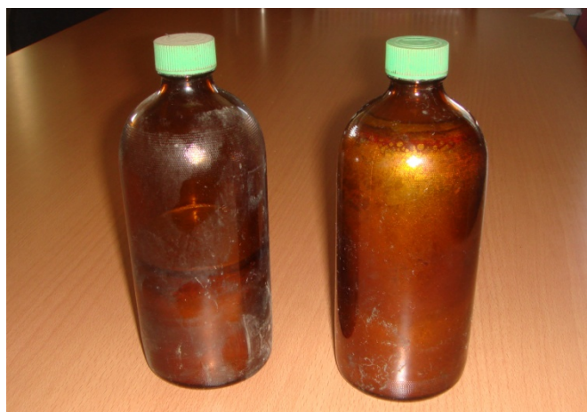
写真3 取壊し工事が始まって出てきた水銀のビン
