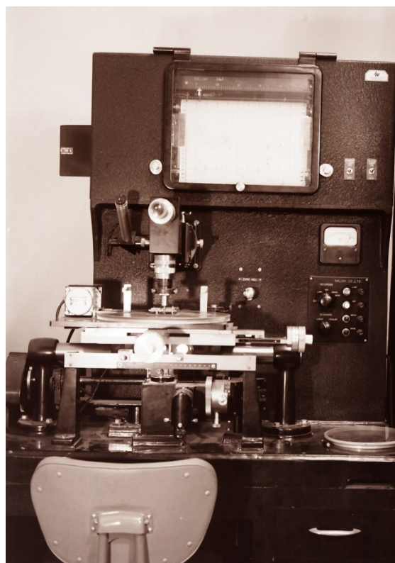
写真2 三鷹にあったマイクロフォトメーター 写真3が、マイクロフォトメーターによるスペクトルの一例である。
