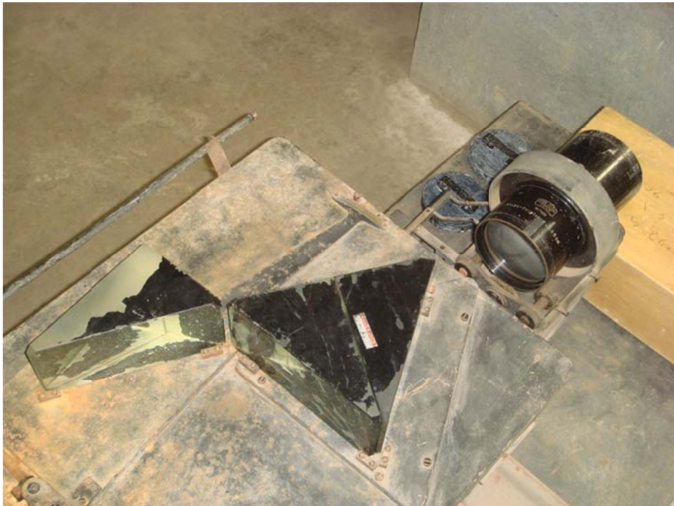
3個の大型プリズムによる分光器
