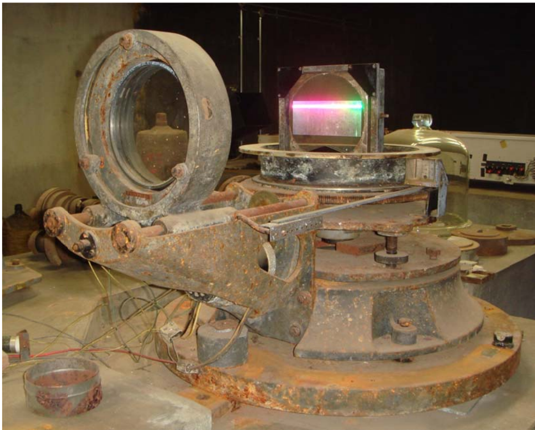
ツアイス製 分解能 220,000 の高分散グレーティング分光器
