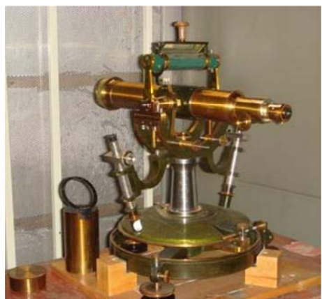
写真 14 バンベルヒ製の27cm一等経緯儀
