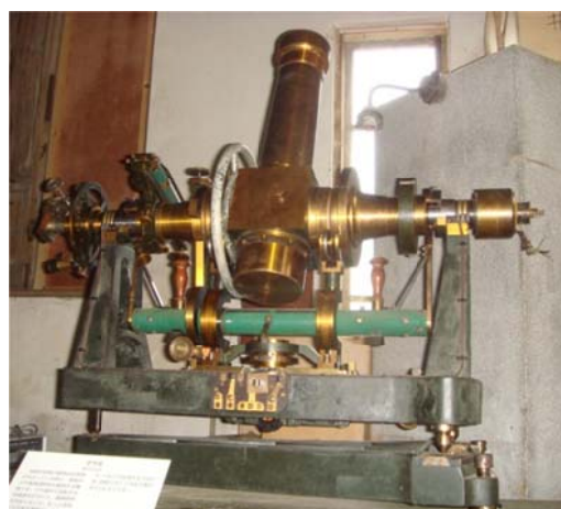
写真2 日本の時刻を決定していた子午儀
