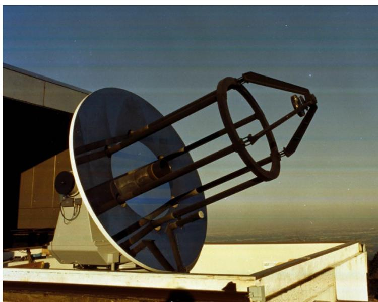
写真6 堂平観測所の月レーザー望遠鏡
