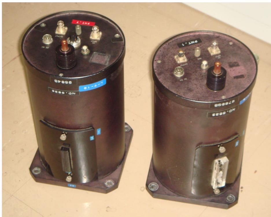
写真2 収蔵した光電子増倍管ユニット2個
