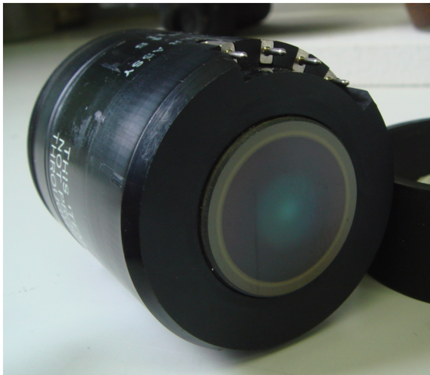
写真2 光電面に「ヤケ」が出来ている 再結像される蛍光面（写真3）は無事のように見える。
