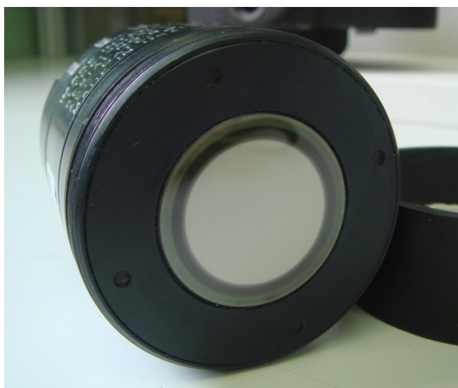
写真3 像が再結像される蛍光面
