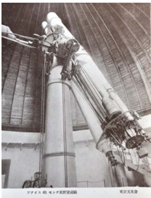
ツァイス 65センチ屈折望遠鏡 東京天文台 写真4 65cm屈折赤道儀望遠鏡
