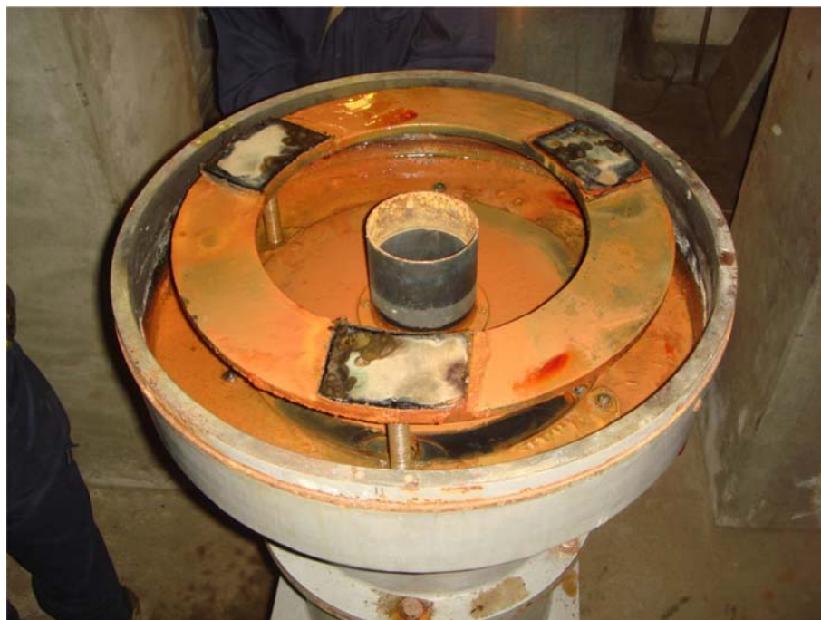
写真8 結露した水で内部が錆びた主鏡セル
