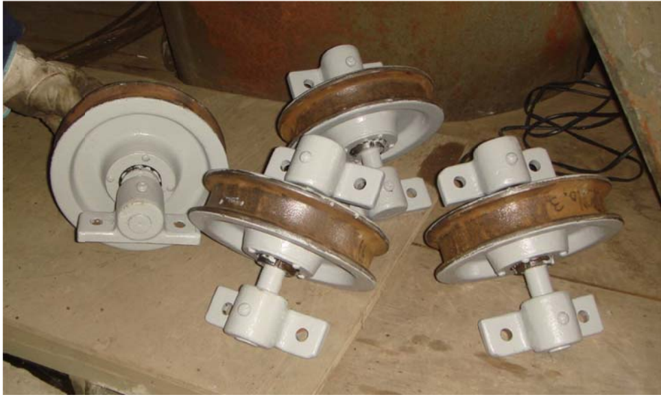
写真5 分解整備され新しく塗装されて帰ってきた車輪
