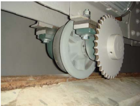
写真6 追加された2個の駆動輪
