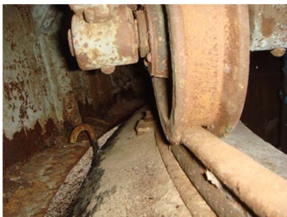
写真1 錆のひどい車輪-1
