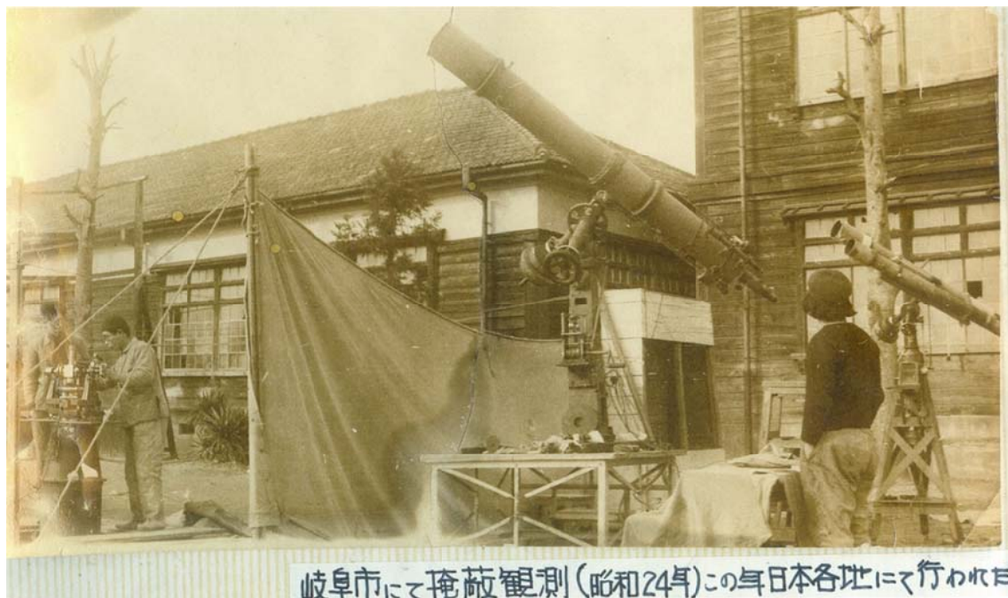
写真2 射場観測所の7吋半屈折赤道義望遠鏡と思われる望遠鏡が写った写真
