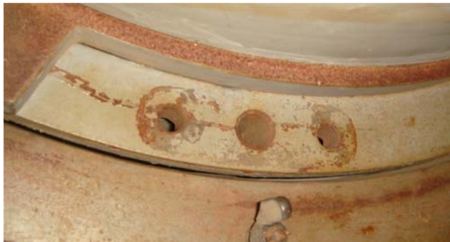
写真 4 治具と符合する穴とボルトねじ穴
