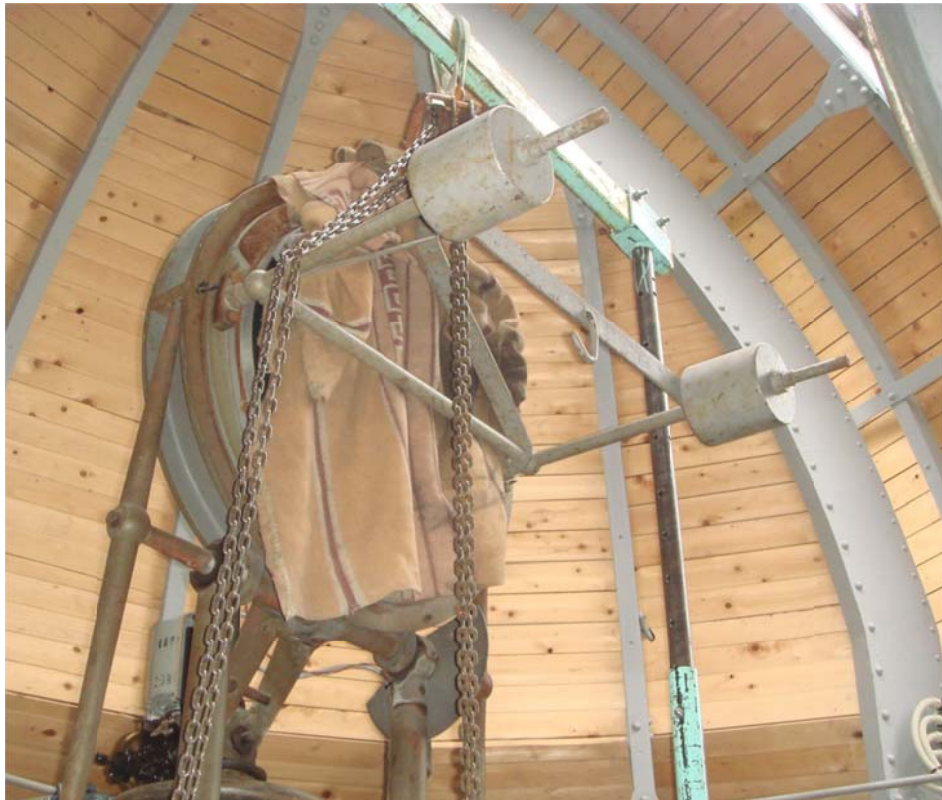
写真6 鏡の入ったミラーセルを枠体から外すところ
