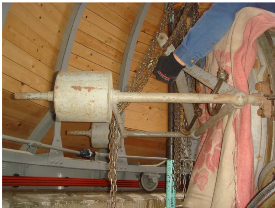
写真 5 治具がミラーセルに取り付けられたところ
