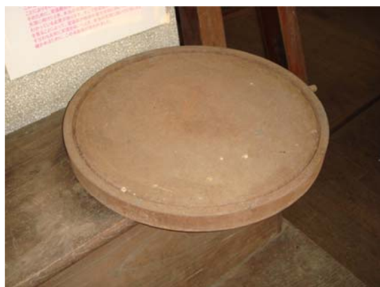
写真2 レプソルド子午儀用水銀盤
