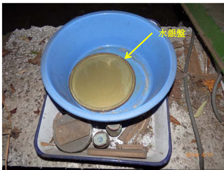
写真6 ゴーチェ子午環地下室で発見された水銀盤
