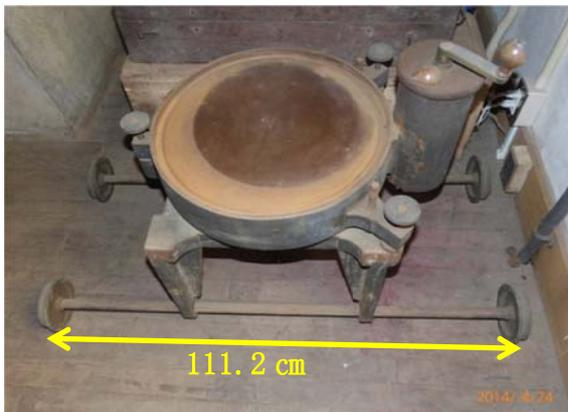
写真4 車輪のつばの外法が 111.2 cm
