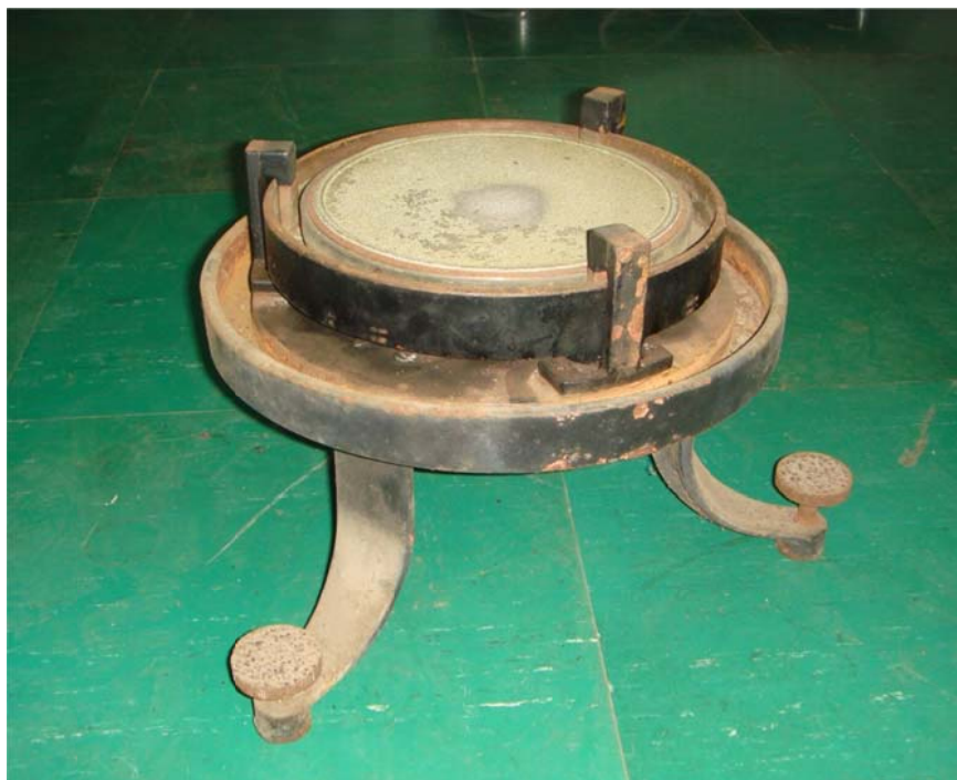
写真9 2重になった写真天頂筒の水銀盤
