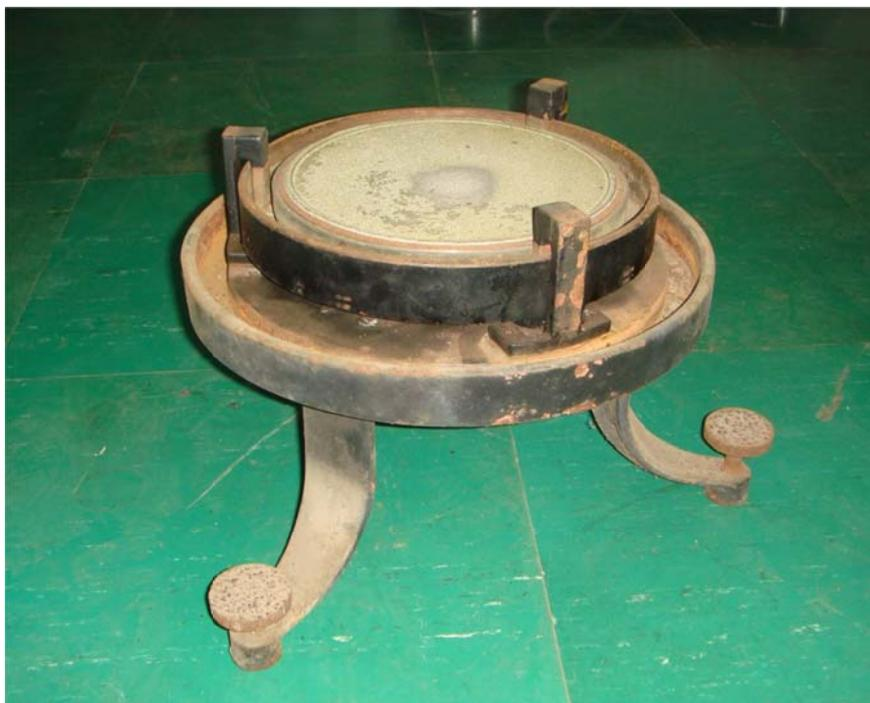
写真9 2重になった写真天頂筒の水銀盤
