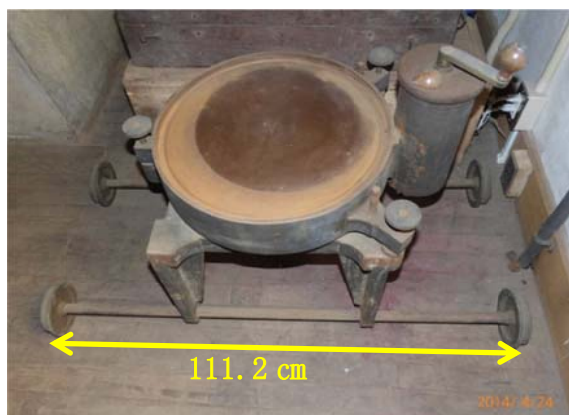
写真4 車輪のつばの外法が 111.2 cm
