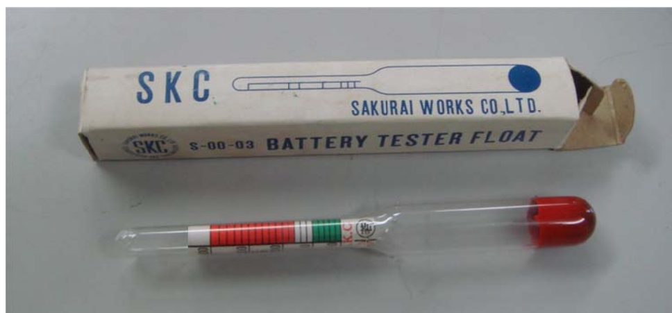
写真2 BATTERY TESTER FLOAT の小箱と本体
