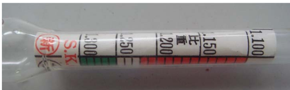
写真4 BATTERY TESTER FLOAT の目盛
