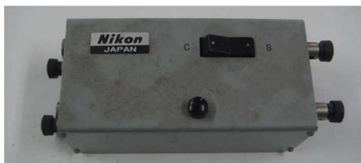
写真4 ニコンFモータードライブの電源系電気
