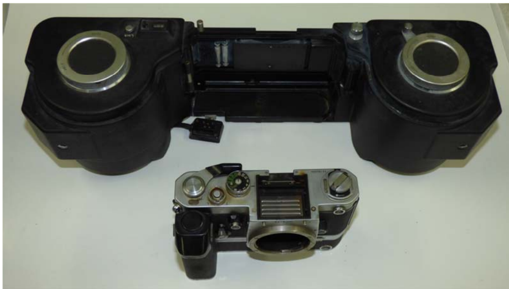
写真3 F2 カメラを外したところ
