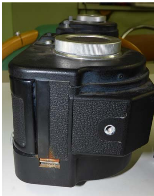
写真3 錆びた裏蓋の止金
