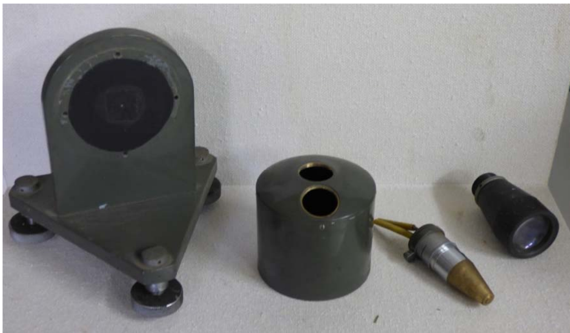
写真2 レンズ、光源、それらの取り付け具を外したところ
