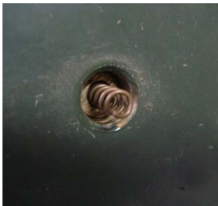
写真 5-3、4 点光源は後ろから右のネジによりスプリングで押されている
