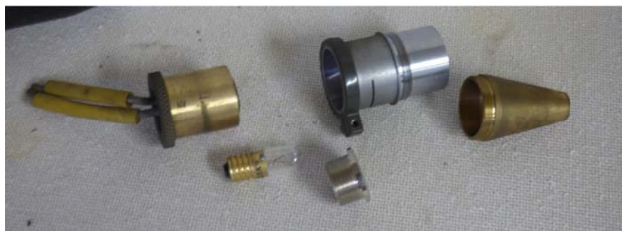
写真4 光源部を分解したところ
