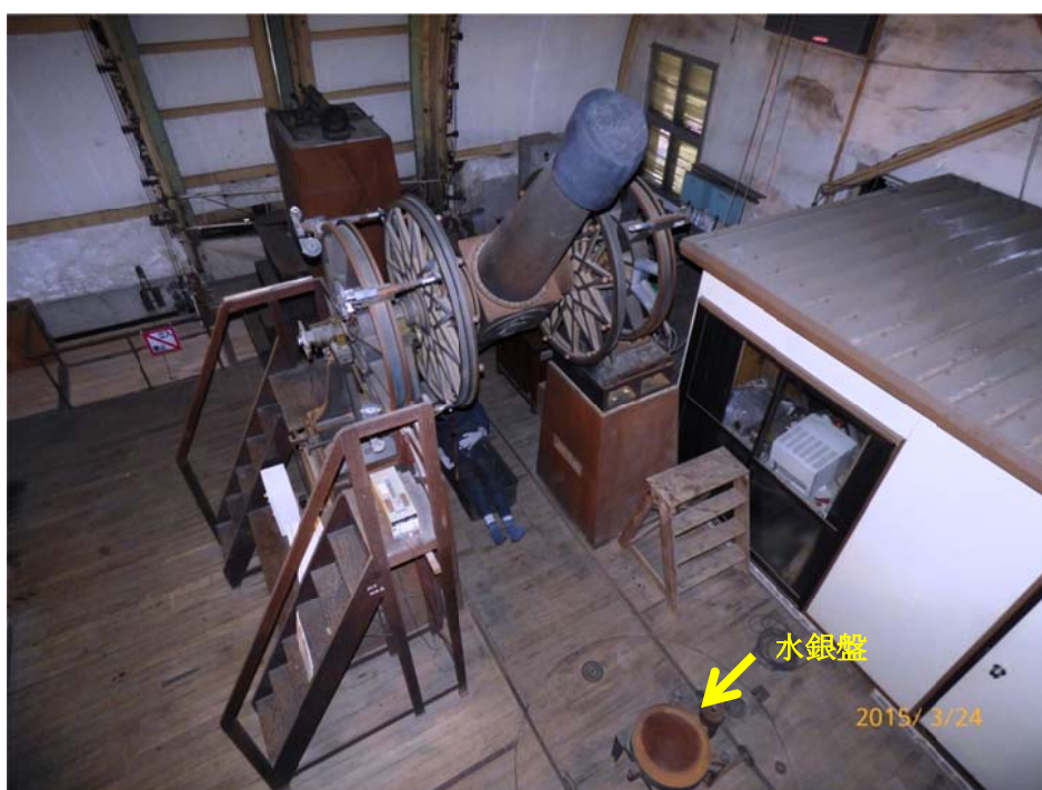
写真6 ゴーチェ子午環と床のレール上に置かれた水銀盤
