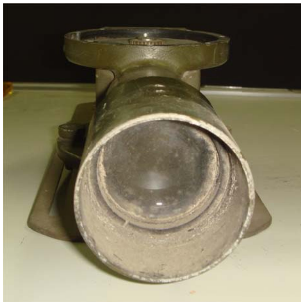
写真5 レンズ側から見たエルボーの様子
