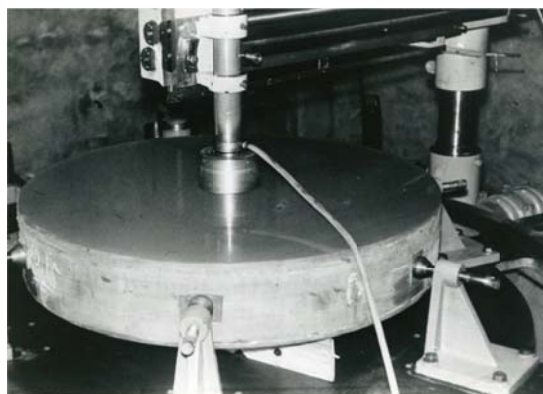
写真 2 主鏡中央孔索作業
