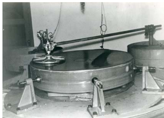
写真 4 研磨中の 91 cm 主鏡
