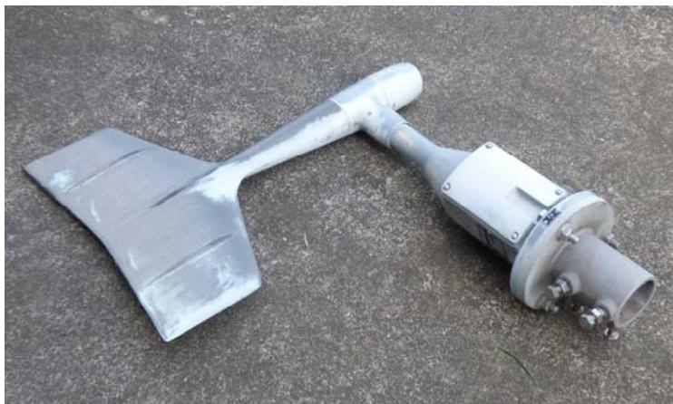
写真 6 回転翼が吹き飛んだ風向風速計
