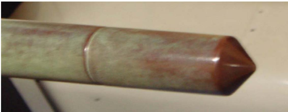
写真 10 先端が磨いたように見える避雷針
