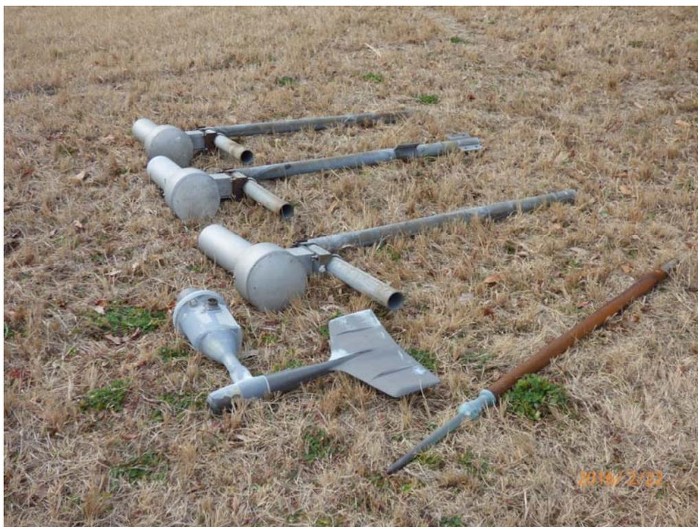
写真 1 鉄塔から外された温度センサー、風向風速計、避雷針
