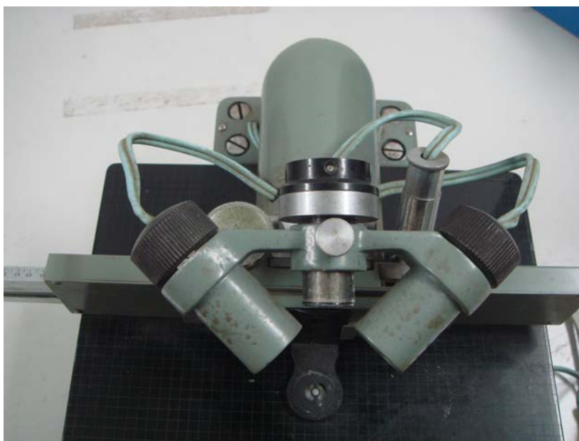
写真 19 被検体の照明部 対物レンズの筒に取り付けられている
