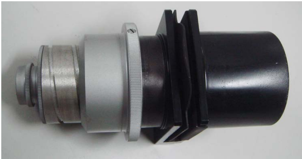
写真6 光学系部 左が焦点合わせヘリコイド
