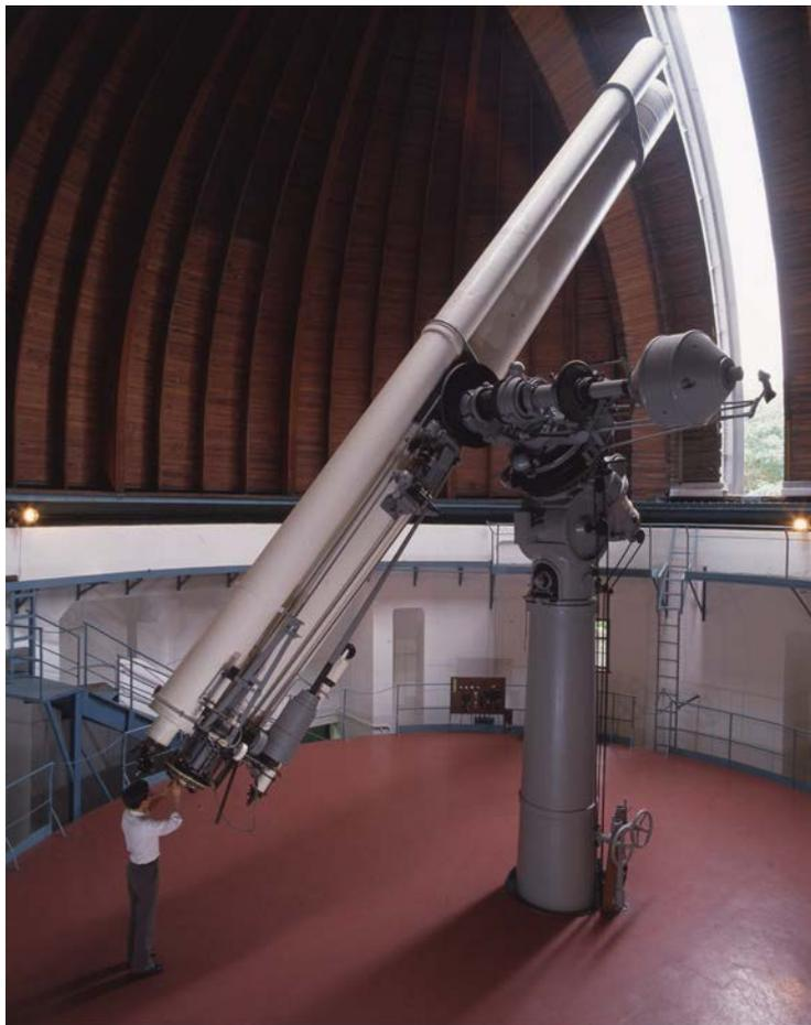
写真1 65 cm屈折望遠鏡
