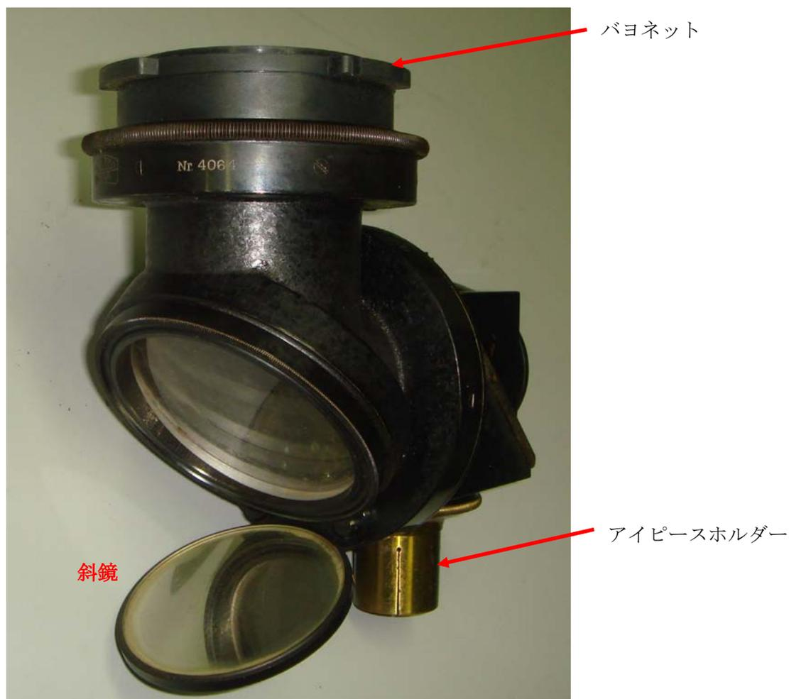
写真5 全体の姿 望遠鏡側を見る斜鏡がある
