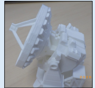
(6) (3：架台＋ヨーク部) に (5：主鏡部) をはめ込む
