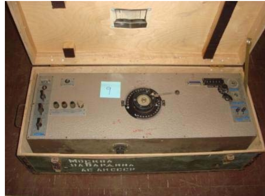
写真 14 制御部・ファインダー架台
