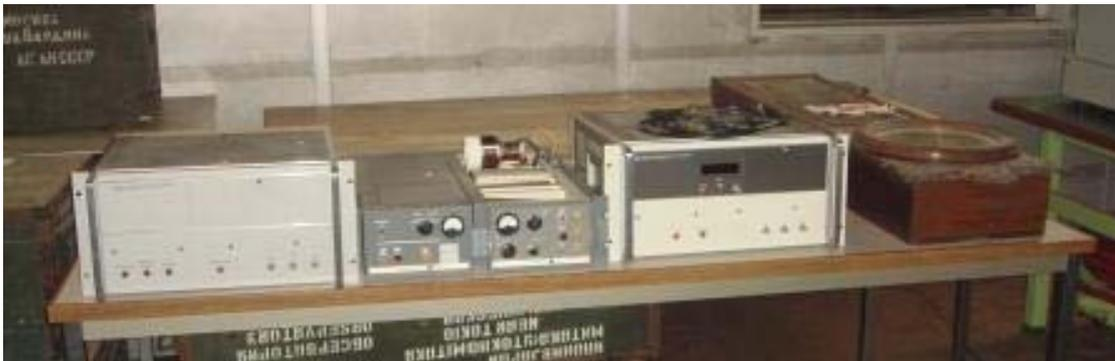
写真 4 左からルビジウム原子時計、セシウム原子時計、柱時計
