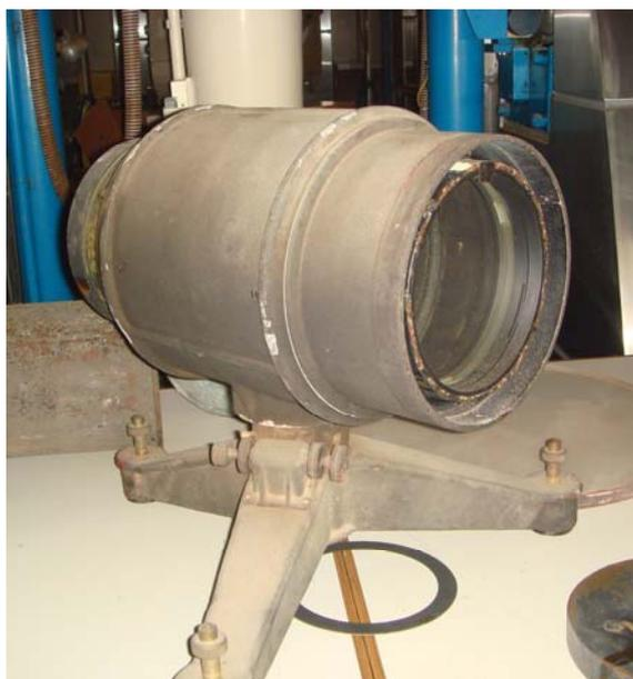
写真1 塔望遠鏡分光器カメラレンズ
