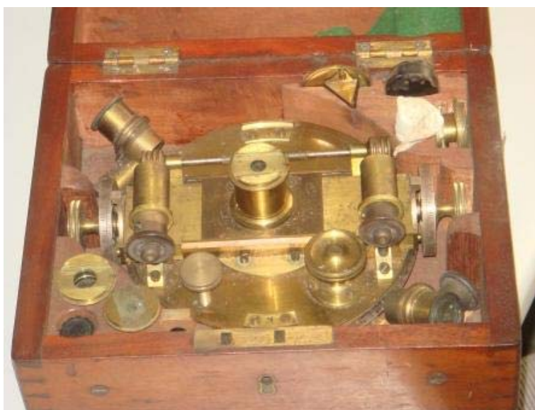
写真2 経緯儀の接眼部のようなマイクロメーター
