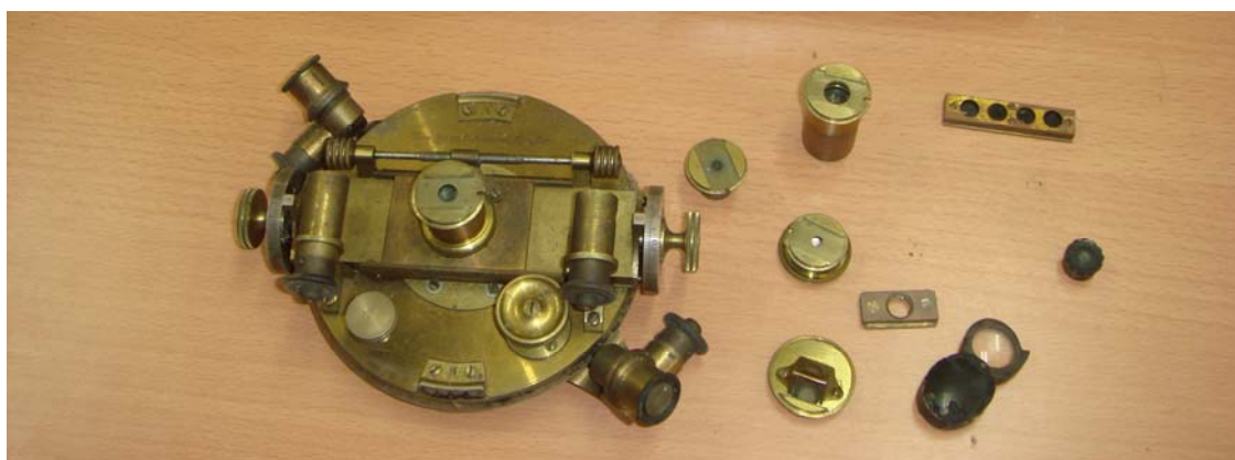
写真4 接眼部の多数の交換部品、フィルター、90度プリズム、ルーペなど
