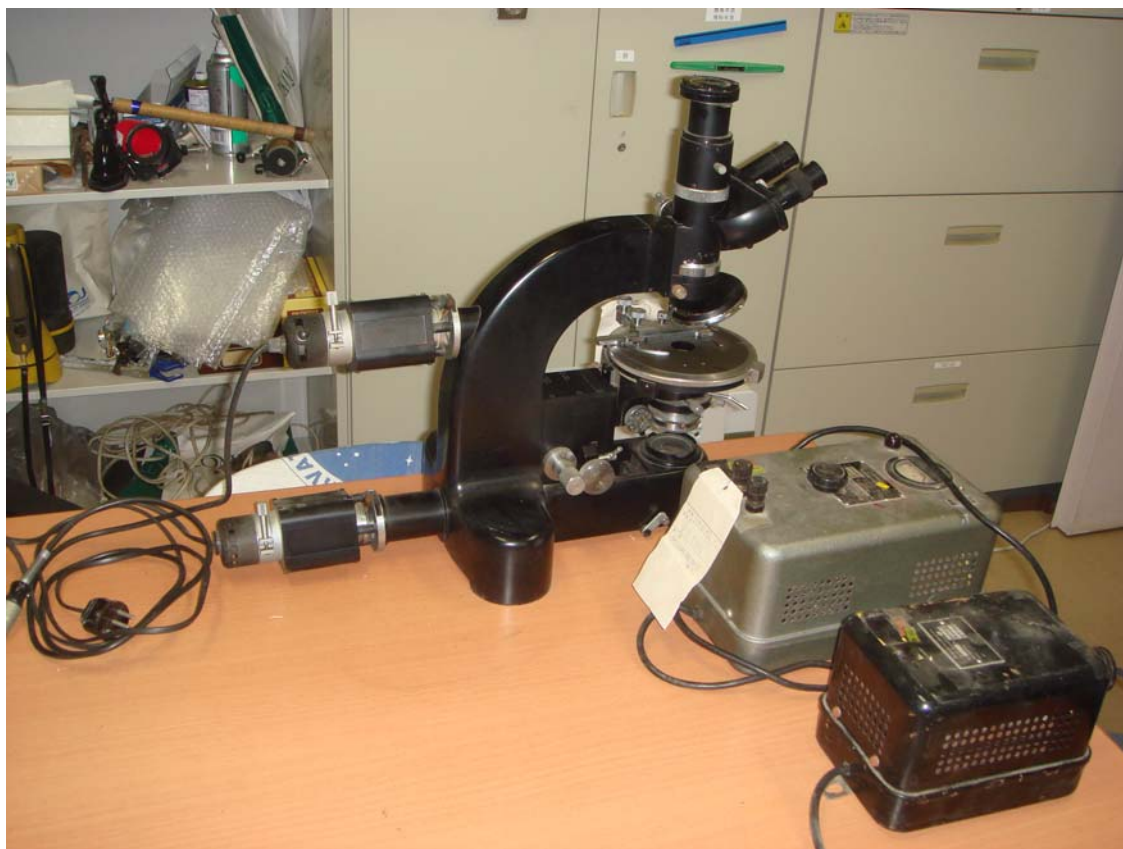
写真6 後方からの2個の光源と2個のトランス
