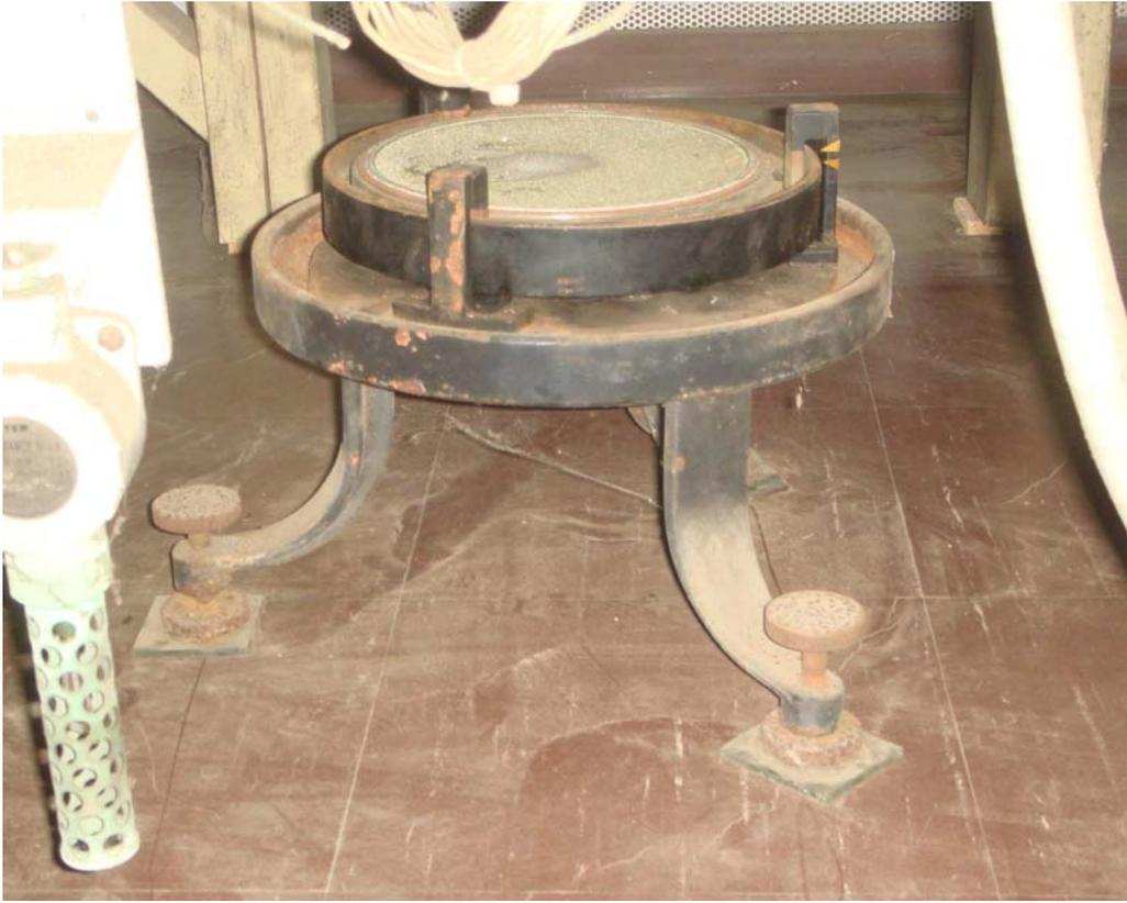
写真3 望遠鏡最下部の水銀盤
