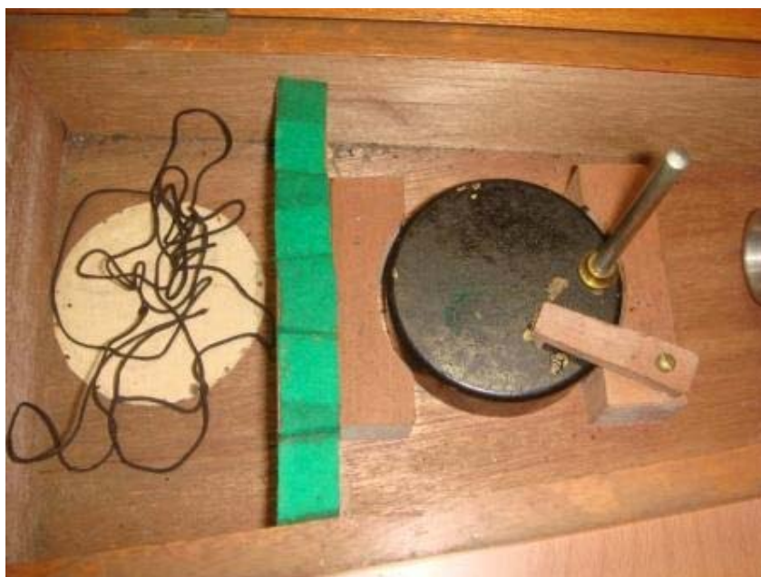
写真 12 木箱の左端には黒い糸、その右に支点の重り
