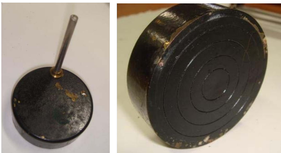
写真5 支点に使う支柱の付いた重りとその裏
