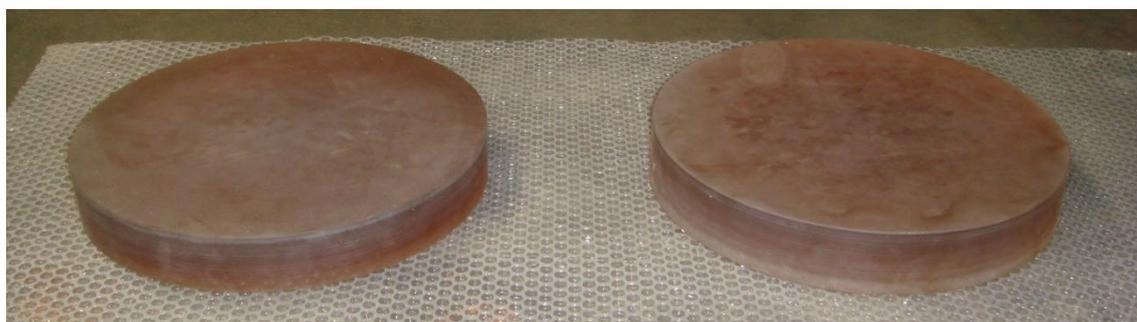
写真2 2枚のクリストロンゼロ鏡材
