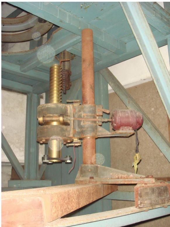
写真4 軸外しの反射望遠鏡の副鏡の焦点移動機構
