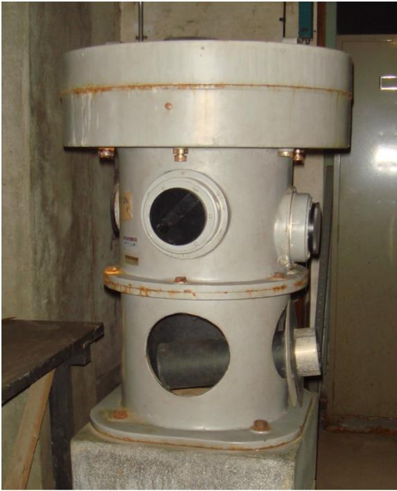
日本光学製の 45cm 反射望遠鏡主鏡部
