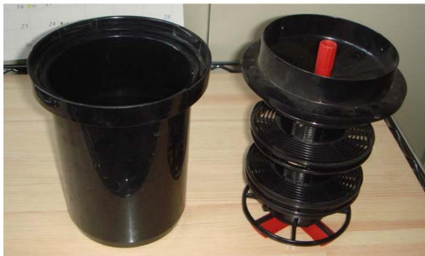
写真6 35mm フィルム 3 ロール用現像タンク (フィルムリール、攪拌用心棒付き)
