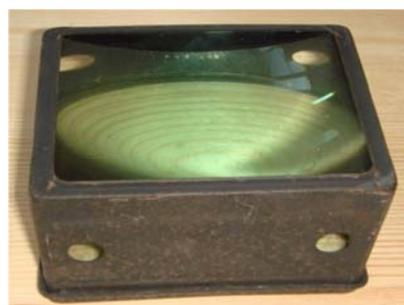
写真4 平凸コンデンサーレンズ 写真5 四角のコンデンサーレンズ
