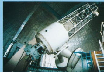
岡山天体物理観測所 188cm反射望遠鏡
