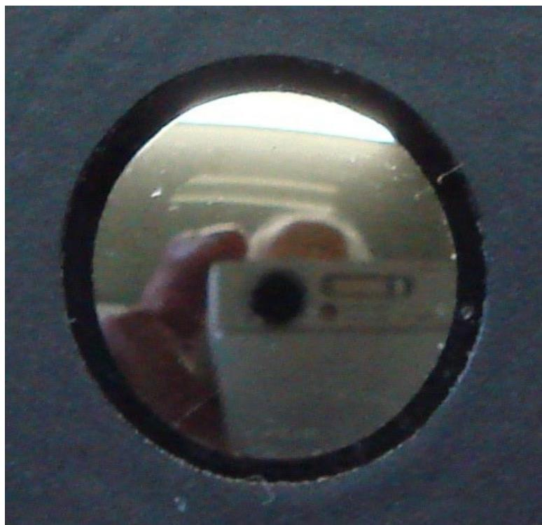
写真3 光電面が凸面になっている
