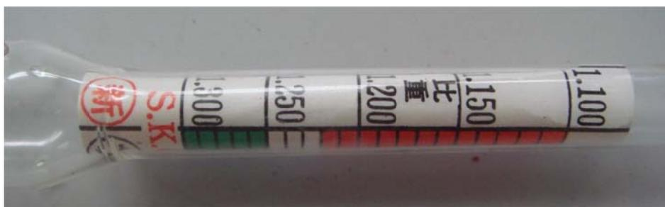
写真4 BATTERY TESTER FLOAT の目盛
