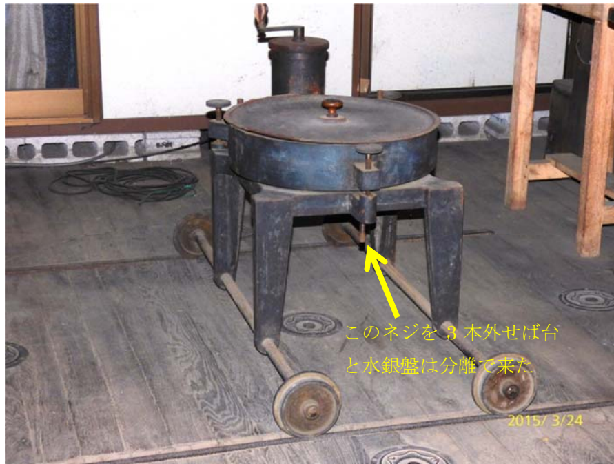
写真4 ゴーチェ子午環室のレール上に置かれた水銀盤
