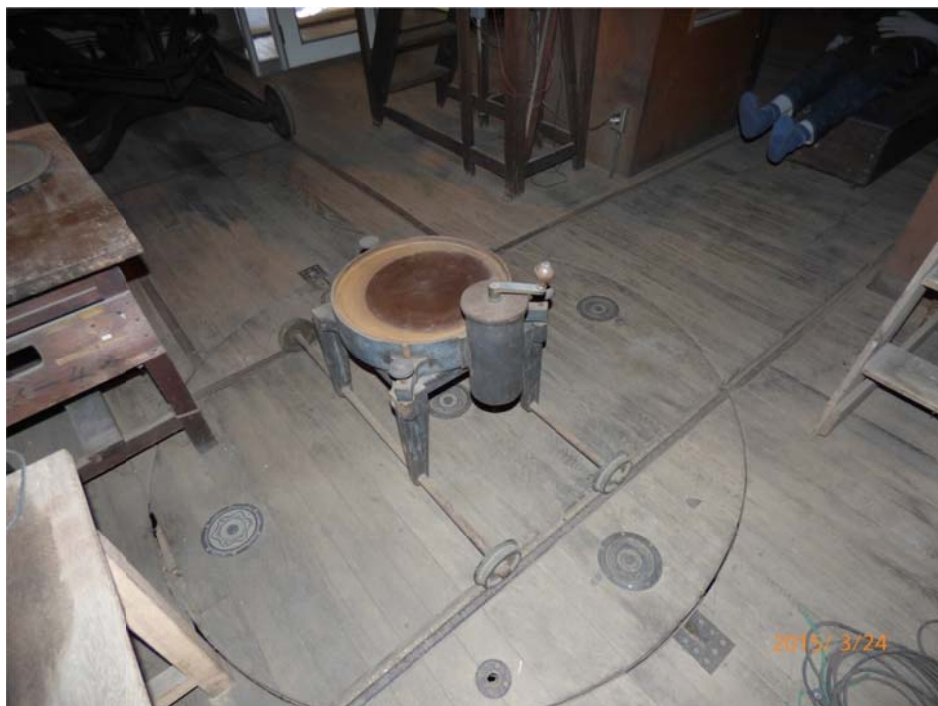
写真5 ゴーチェ子午環室の方向転換用回転用のレール上に置かれた水銀盤
